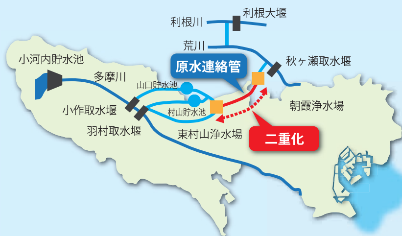
原水連絡管※4の二重化
