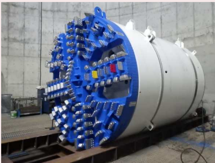
▲トンネル掘削に使用するシールドマシン(東村山境線(仮称)) トンネル築造等の工事を実施しています。
