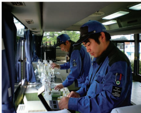
▲ 水質試験車内での水質検査
