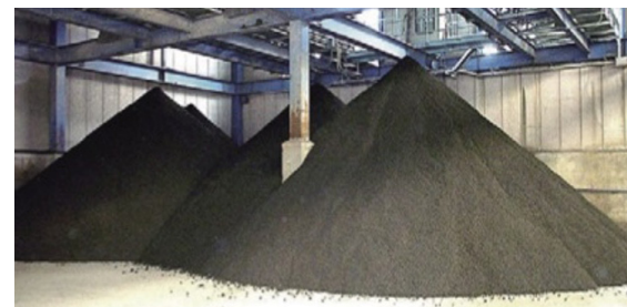
浄水場発生土
