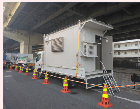
ソーラー電源による移動仮設事務所
