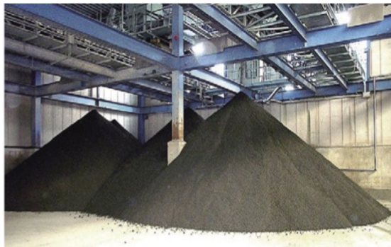
浄水場発生土
