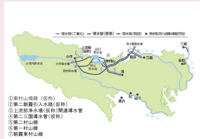
▲導水施設の二重化・更新の概略図
