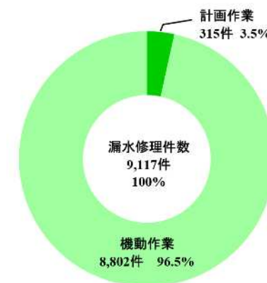
図4 機動作業と計画作業の比較 （令和6年度修理件数）
