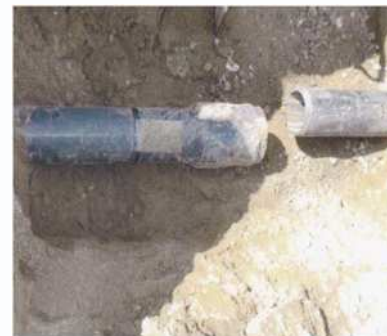
＜漏水した塩化ビニル製の給水管＞
