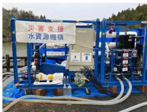
可搬式浄水装置 (独)水資源機構
