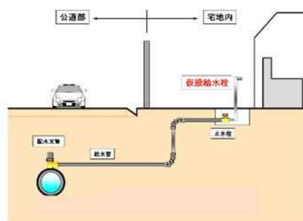
仮設給水栓の一例
