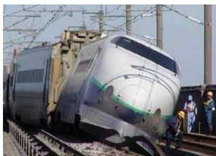
上越新幹線浦佐駅～長岡駅間 列車脱線事故 (新潟地方気象台：新潟県中越地震より)
