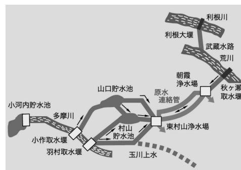
図2-14 利根川と多摩川との連絡施設
