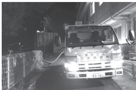
病院の受水槽への給水作業（清川村）
