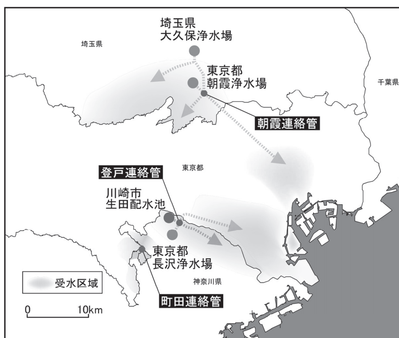
図 3－13 連絡管による受水区域
