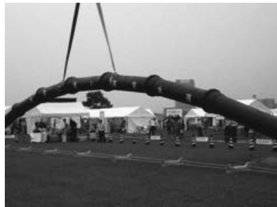
抜け出し防止機能を有する耐震継手管
