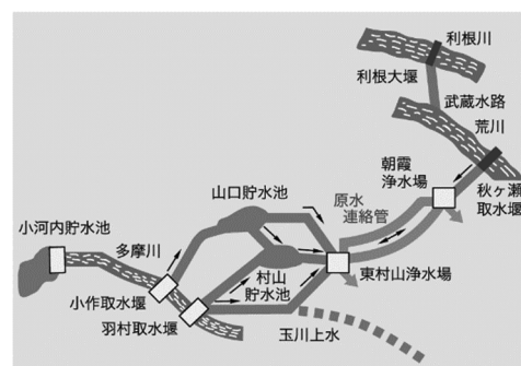
図2-14 利根川と多摩川との連絡施設
