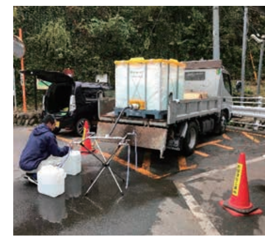
▲ 組み立て式のタンクからの給水
