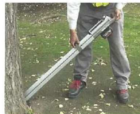
○ 貫入抵抗測定器での測定状況
