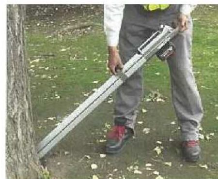
○ 貫入抵抗測定器での測定状況
