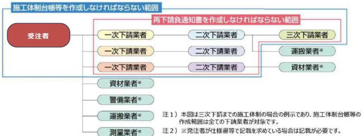
図5-1: 施工体制台帳の作成すべき範囲(・三次下請まである場合の例)
