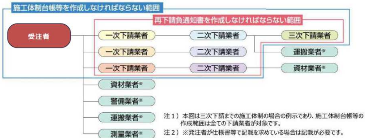
図5-1: 施工体制台帳の作成すべき範囲(・三次下請まである場合の例)
