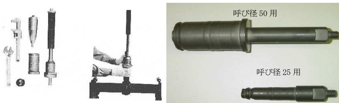
図－5 取付け工具及び共通先端ストレッチャー
