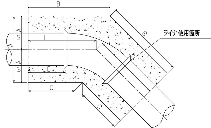
(※) E寸法は、現場で防護端面位置を設定する際の参考値として、算出した値である。このため、他の継手形式でE寸法を算出する必要がある場合は、L寸法を基に別途算出する。
