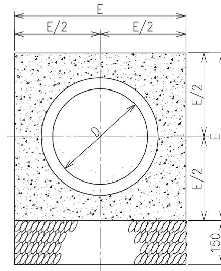
フランジ継手防護工
