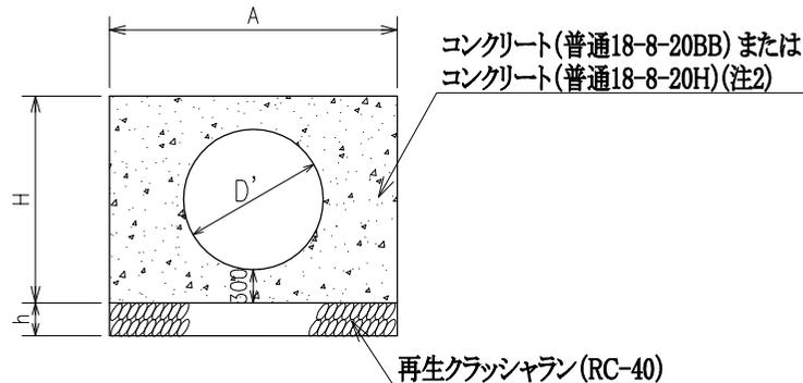
(注2) コンクリートの種別は、普通18-8-20BBを標準とするが、施工条件により配水管工事標準仕様書に定める養生期間が確保できない場合は、コンクリート(普通18-8-20H)を使用することもできる。
