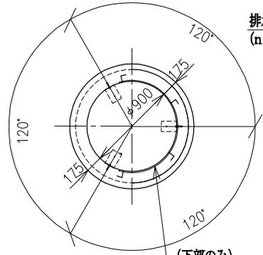
(下部のみ) ステンレス鋼板 (SUS304) t=3mm
