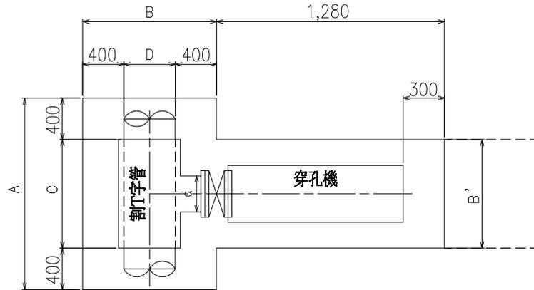
※B'は新設掘削幅とする。
