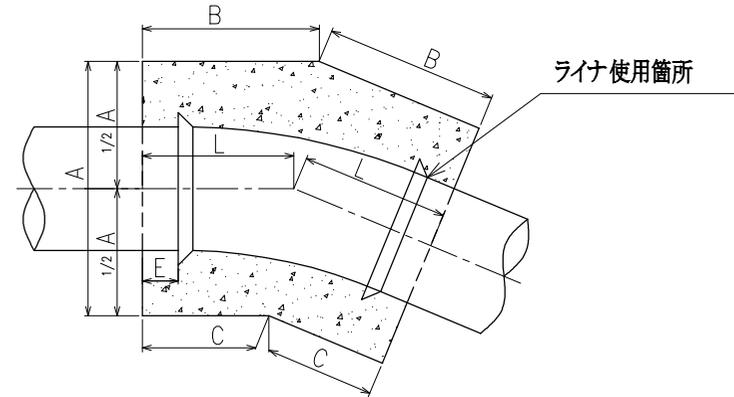
(※) E寸法は、現場で防護端面位置を設定する際の参考値として、算出した値である。このため、他の継手形式でE寸法を算出する必要がある場合は、L寸法を基に別途算出する。
