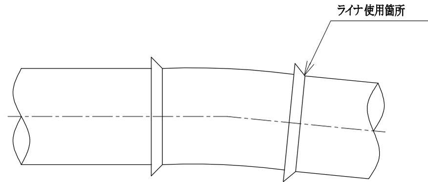
(注) 異形管の挿し口と直管の受口部には、ライナを使用する。
