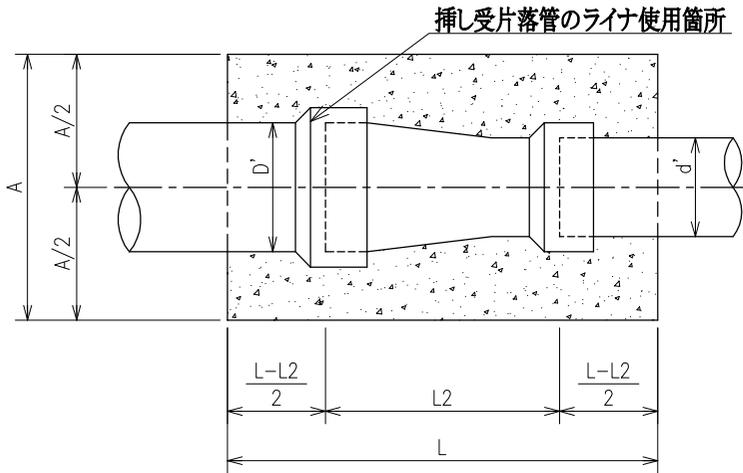
(注1) 異形管の挿し口を直管の受口に接合する場合は、ライナを使用し、コンクリート防護を行う。
