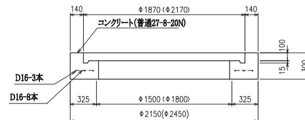
(備考) 本図は呼び径700~800の制水弁室にも適用する。その際、側塊及びリング底版の寸法は( )内のものを用いる。
