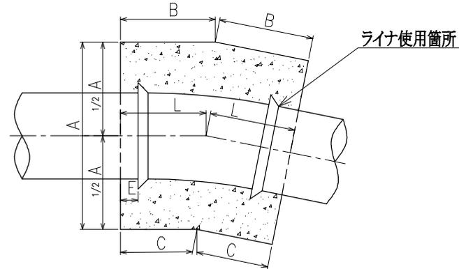
(※) E寸法は、現場で防護端面位置を設定する際の参考値として、算出した値である。このため、他の継手形式でE寸法を算出する必要がある場合は、L寸法を基に別途算出する。
