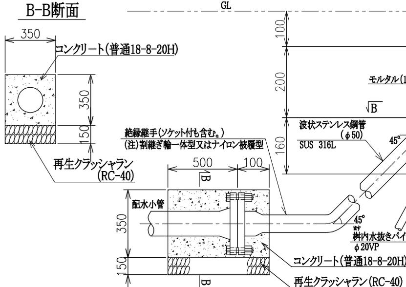
※ 水圧が0.4MPaを超える場合及び標準的な土被り(浅層埋設の場合は0.8m)が確保できない場合は別途考慮する。
