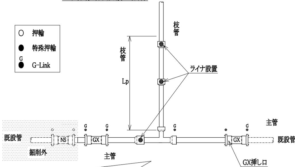
(例4)【T字管防護(枝管側防護)】 枝管側でライナによる一体化長さ(Lp)が得られているので、主管側(Lp)に特殊押輪による管防護工が施されていない接合部又は確認できない接合部が存在しても、異形管(T字管)にコンクリート防護工は不要となる(異形管挿口接合部にはライナ必須)。
