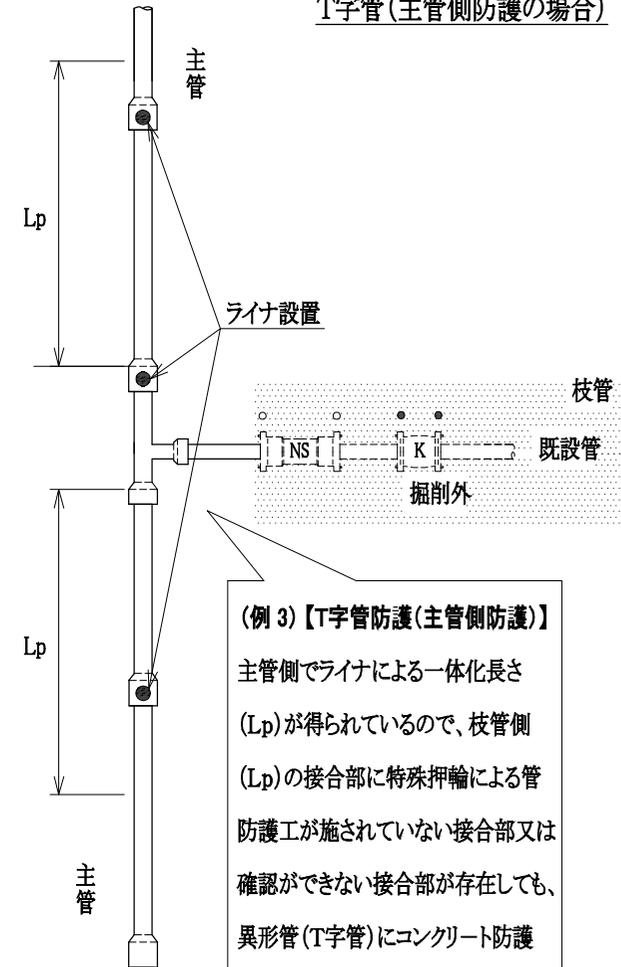
(例3)【T字管防護(主管側防護)】 主管側でライナによる一体化長さ(Lp)が得られているので、枝管側(Lp)の接合部に特殊押輪による管防護工が施されていない接合部又は確認ができない接合部が存在しても、異形管(T字管)にコンクリート防護工は不要となる(異形管挿口接合部にはライナ必須)。
