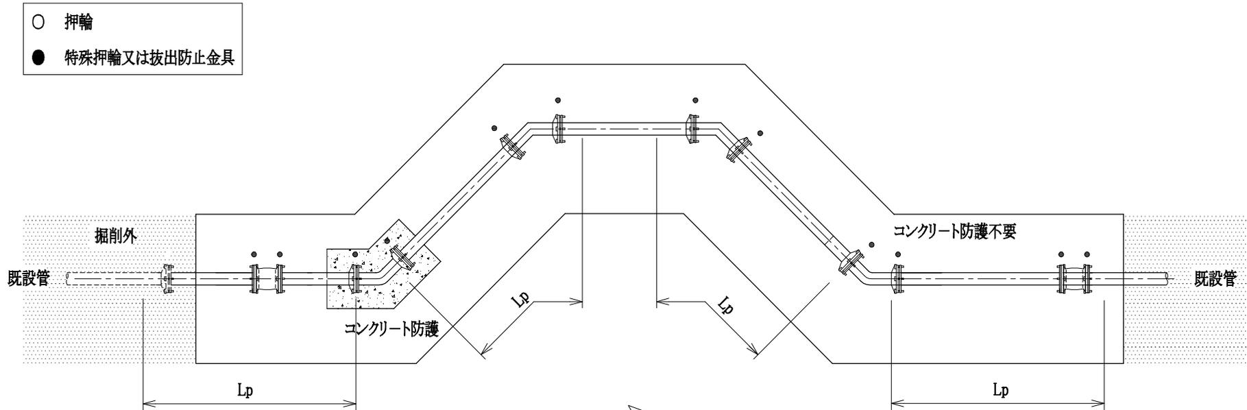
(例5)【既設管の防護】一体化長さ(Lp)の中に特殊押輪若しくは拔出防止金具が施されていない場合又は、それぞれが施されているかの確認ができない場合は、コンクリート防護工又は「配水防護標準図」(平成30年)による鋼材防護工を施す。
