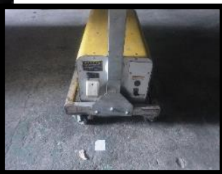
○内照式工事標示板（LED ライト）により 排気ガス・騒音の低減
