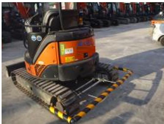
○バックホウに「巻き込まれ防止バー」を設置
