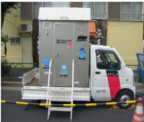
○移動式トイレカーの設置
