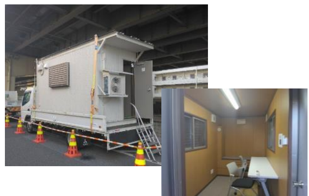
○ソーラー電源による移動仮設事務所を設置
