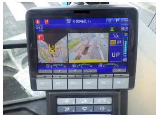
○左右後方の3箇所カメラを搭載したアラウンドビューモニターを使用
