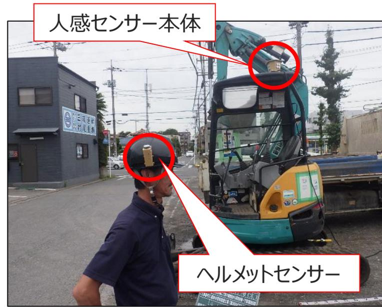
バックホウに人感センサーを取り付け
