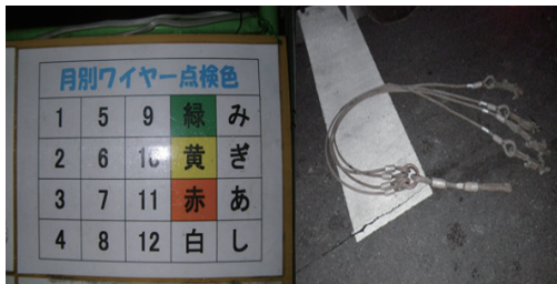
吊索钢丝绳的检查
