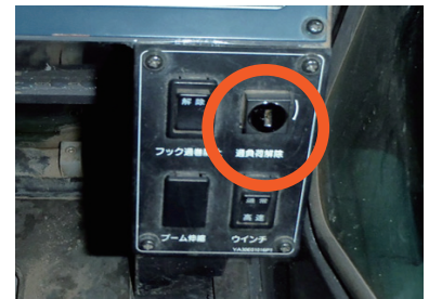
Lỗ cấm “chìa khóa” dùng để vô hiệu hóa thiết bị chống quá tải
