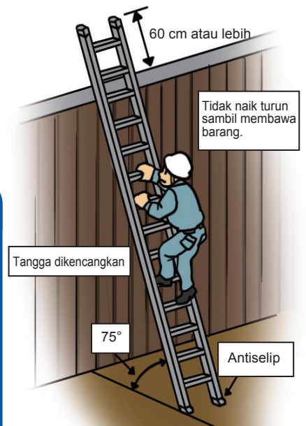
Penempatan tangga yang benar
