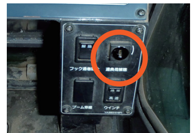
Lubang "kunci" untuk melepas perangkat pencegah beban berlebih
