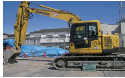
Ekskavator hidrolik ultra-short swing
