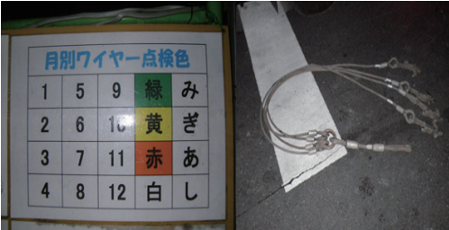
ဆွဲတင်ပစ္စည်း ချိတ်ဆက်ခြင်းပိုင်ယာကြိုးစစ်ဆေးခြင်း
