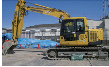
အလွန်အသေးစား လှည့်ပတ်နိုင်သော ဟိုက်ဒရောလစ် တူးဖော်စက်
