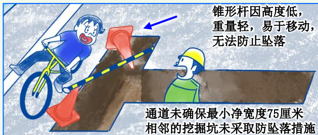
第三方跌落挖掘坑（2022年度）
