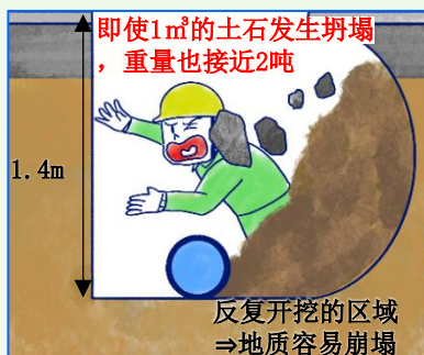
在挖掘1.4m深处发生的山体滑坡（2022年度）
