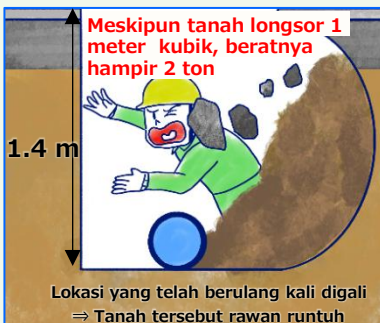
Tanah longsor yang terjadi pada kedalaman galian 1,4 m (Tahun fiskal 2022)
