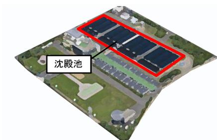
【浄水場の沈殿池の配置例】
