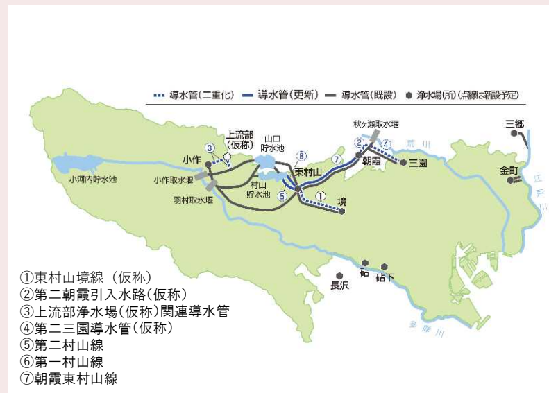
▲導水施設の二重化・更新の概略図
