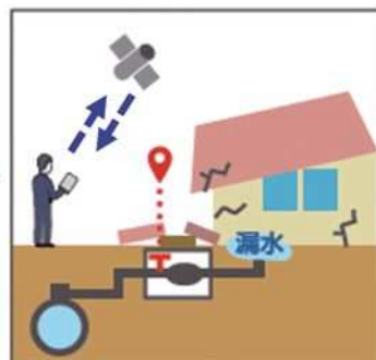
衛星測位により位置特定を迅速化
