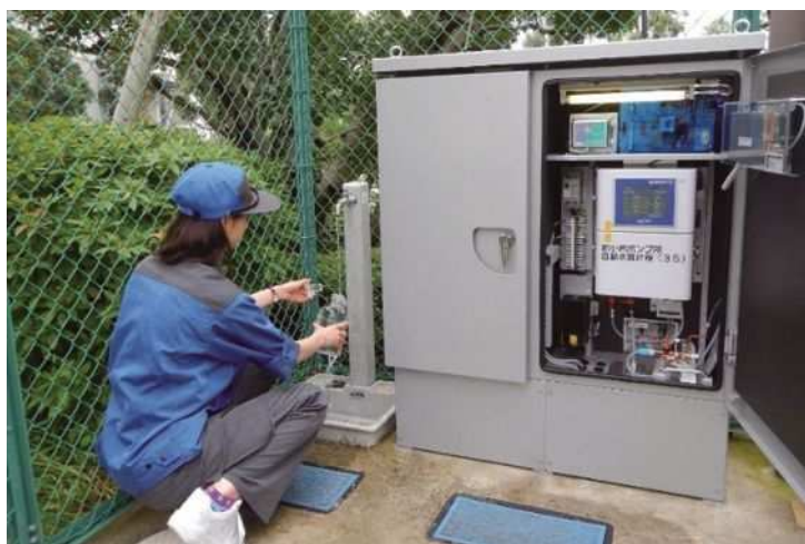
▲給水栓自動水質計器と給水栓の採水の様子
