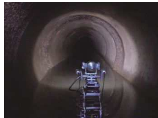
▲自走式ロボットによる導水管の健全度調査の様子
