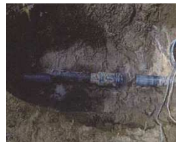
▲漏水が発生した 塩化ビニル製の給水管
