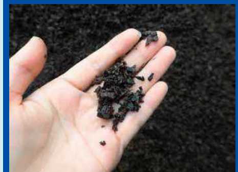
自然侵入促進型植生基材吹付に混ぜるチップ
