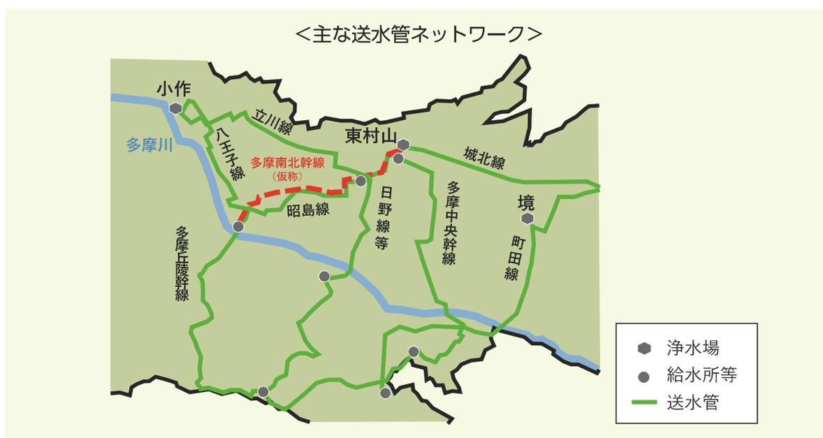
配水管は、再編する配水区域に応じた配水管網や隣接する区域と連絡する管路を充実させることで、災害や事故に加え、更新時のバックアップを強化します。
