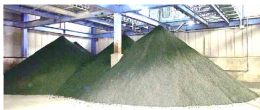
浄水場発生土
