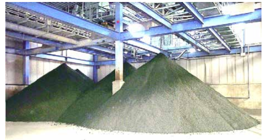
浄水場発生土
