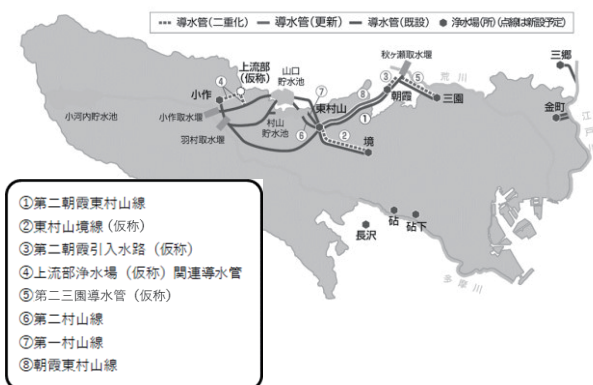
図 3-4 導水施設の二重化・更新の概略図
