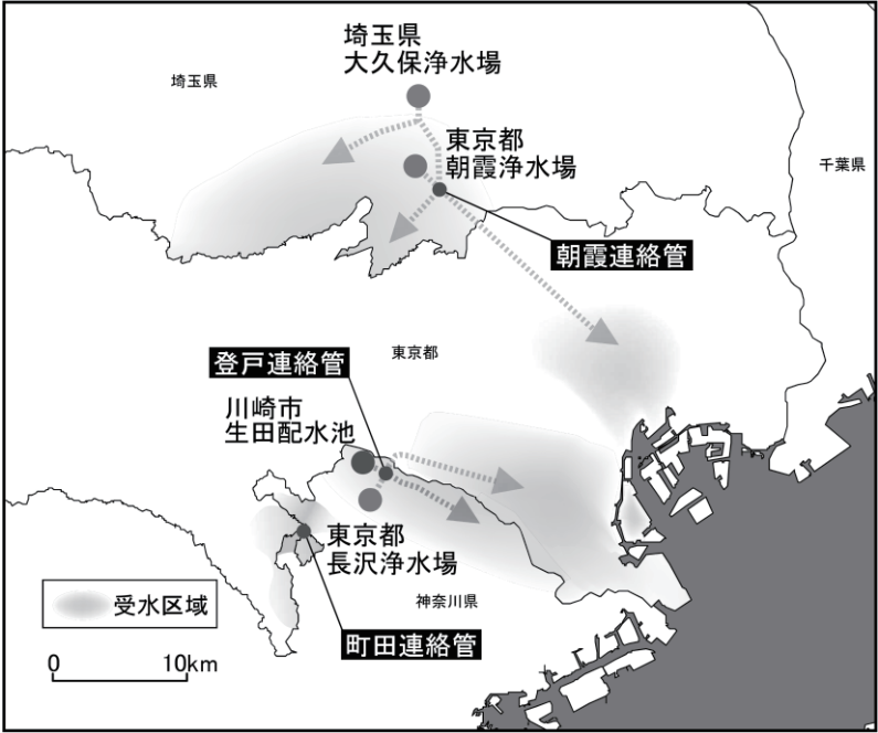
図 3－13 連絡管による受水区域
