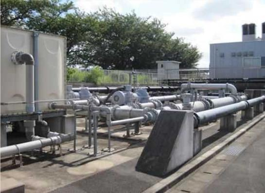
開発フィールドの実験管路において、実際の水道管と同じような流れの状態を再現するため、充水ポンプと循環ポンプが備え付けられています。仕様は次のとおりです。
