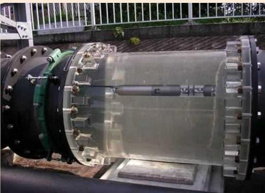
開発フィールドの実験管路の一部に、配管の内側が見えるよう、透明管(アクリル管)になっています。
