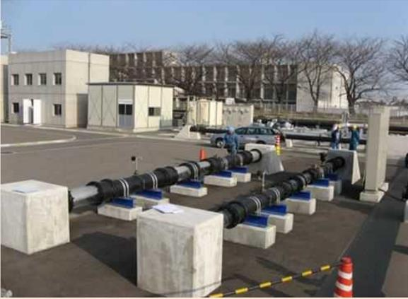
フィールド内には、250mm,350mmのアクリル管も設置しており、例えば、送・配水管路内に発生した錆、塗料片（シールコート）等の夾雑物を効率的に管外に排出する方法の検討等に活用できます。
