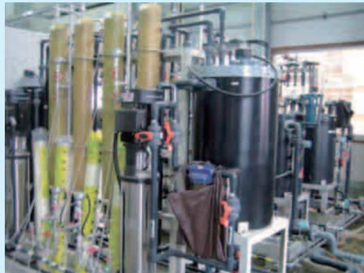
NF膜<sup>※2</sup>処理実験設備
