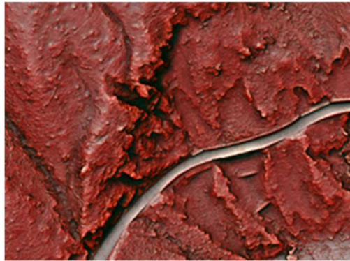
航空レーザー測量の解析調査により作成した地形図(イメージ)
