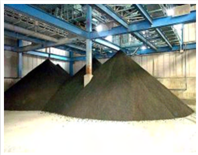
浄水場発生土
