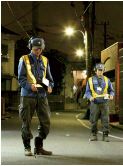
夜間に実施する音聴調査の様子 (地下漏水の早期発見、未然防止)
