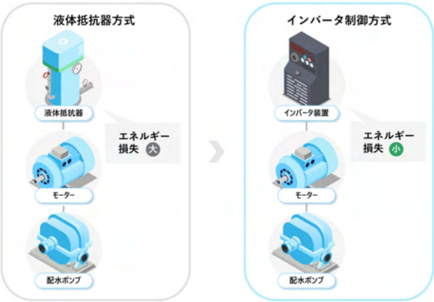
液体抵抗器方式とインバータ制御方式のイメージ
