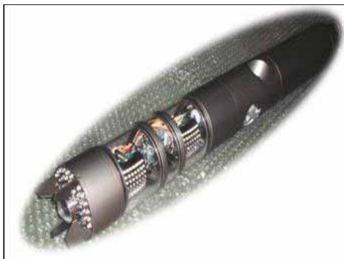
写真 開発品の例（管内調査ロボット）
