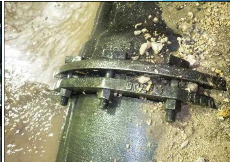
DIP (T形継手  $\phi$ 200mm) の漏水状況
