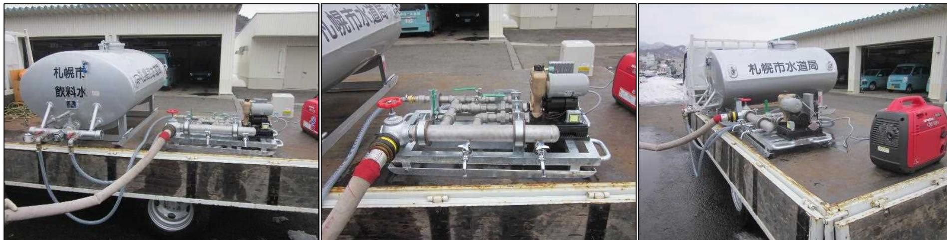
写真-9 車載用給水タンクの加圧装置 ※改良中
