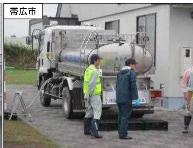
写真-6 給水車(3.1t, 加圧有)
