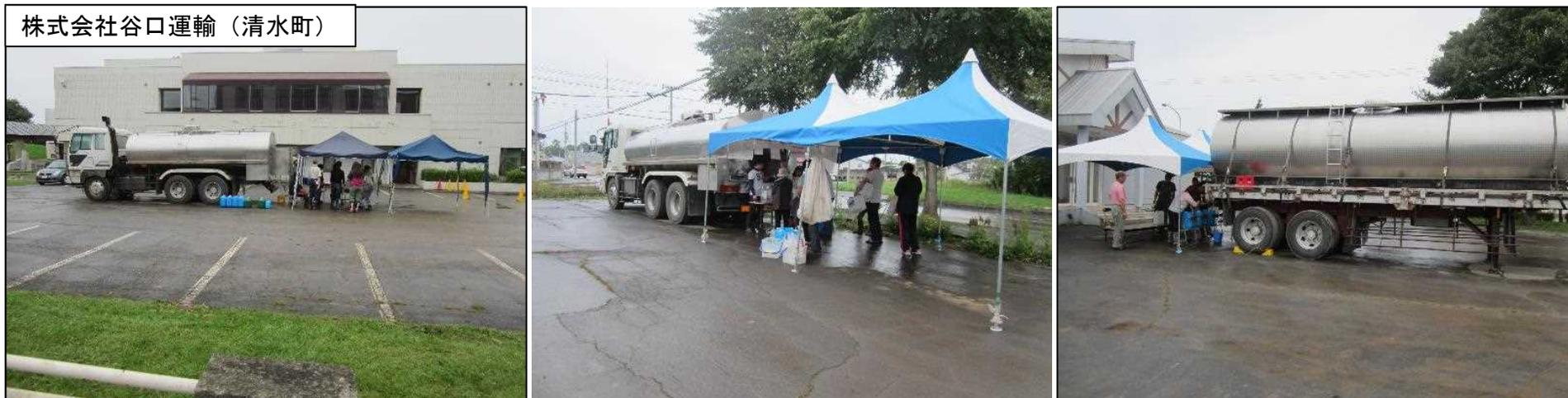
写真-7 ミルクローリー（10t×3台、加圧有）
