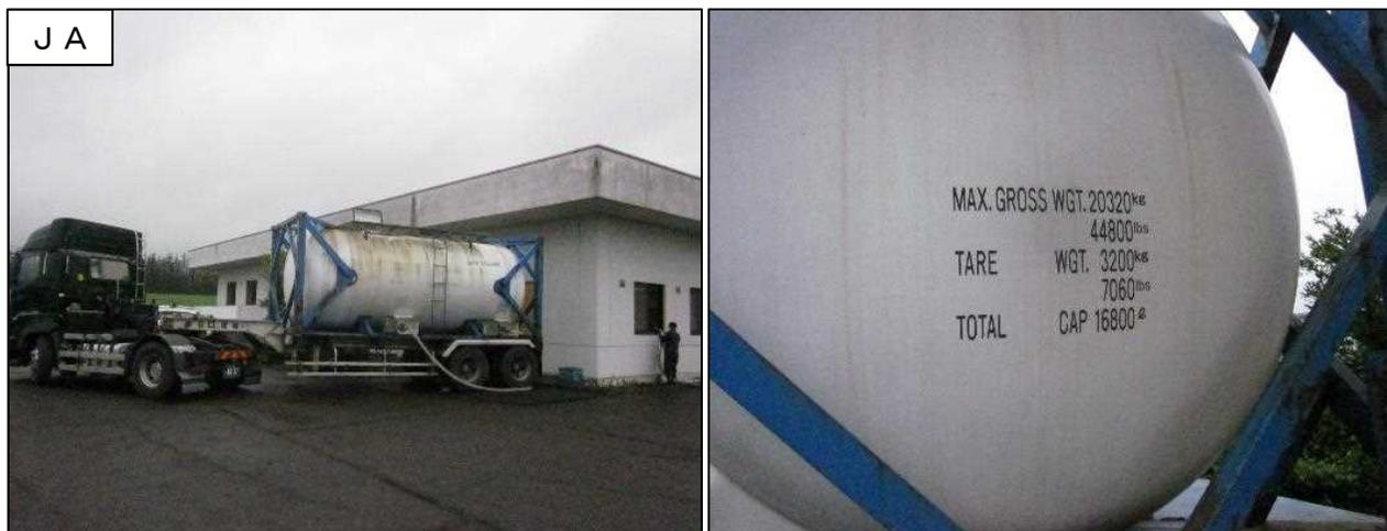
写真-8 ミルクトレーラ（16.8t、加圧有） ※営農用水供給時に使用
