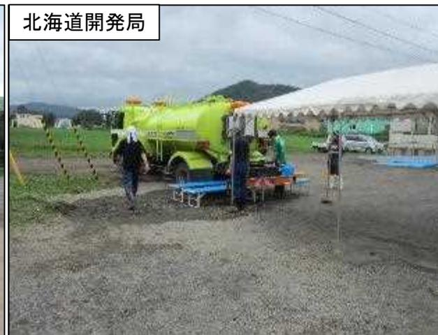
写真-3 散水車(6.3t, 加圧有)
