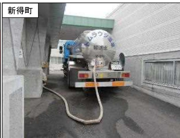
写真-5 温泉輸送車(6t, 加圧有)
