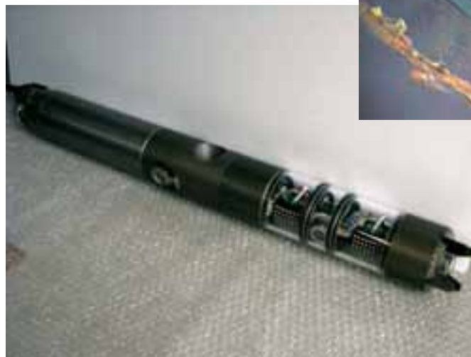
▲管内調査ロボット (右上:配水管内の映像)
