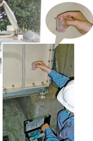
▲ 試薬による水質の確認
