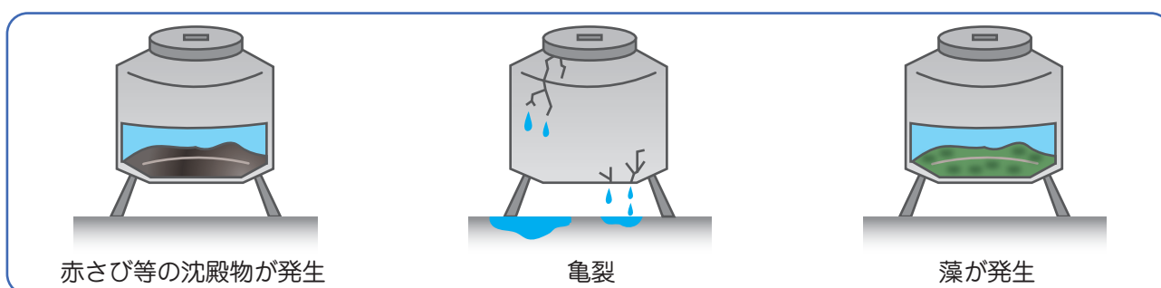
< 貯水槽水道の管理が不十分により生じる問題（イメージ図） >
