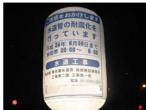
○バルーンライト型工事看板
