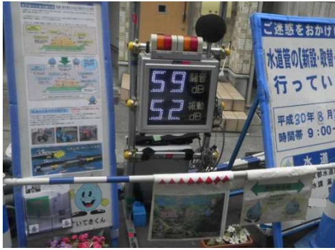
○騒音振動計を設置し、測定データを表示
