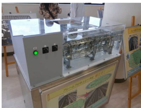
○フロキュレータ（かくはん設備）の模型
