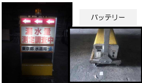
○内照式工事標示板（LED ライト）により 排気ガス・騒音の低減
