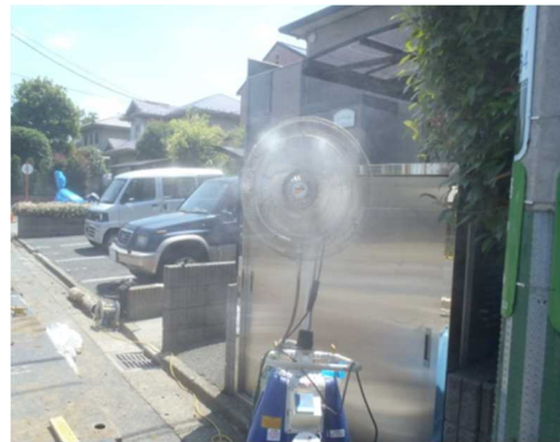
○ミストスプレー機の設置
