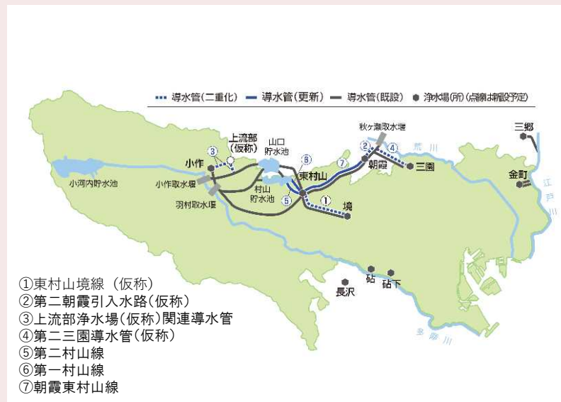
▲導水施設の二重化・更新の概略図
