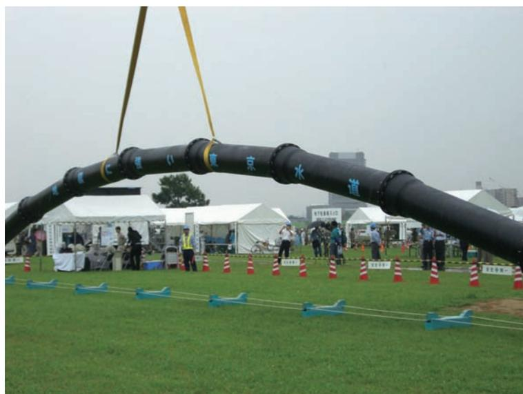
耐震型継手を有するダクタイトイル管
