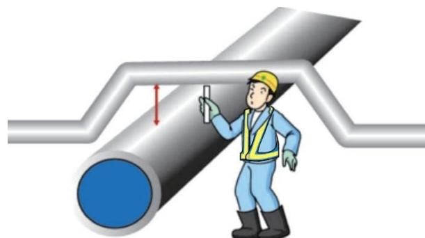
また、水道管に並行して埋設する場合は、離隔が確保されていても、次の図に示すように水道管直上には埋設しないでください。
